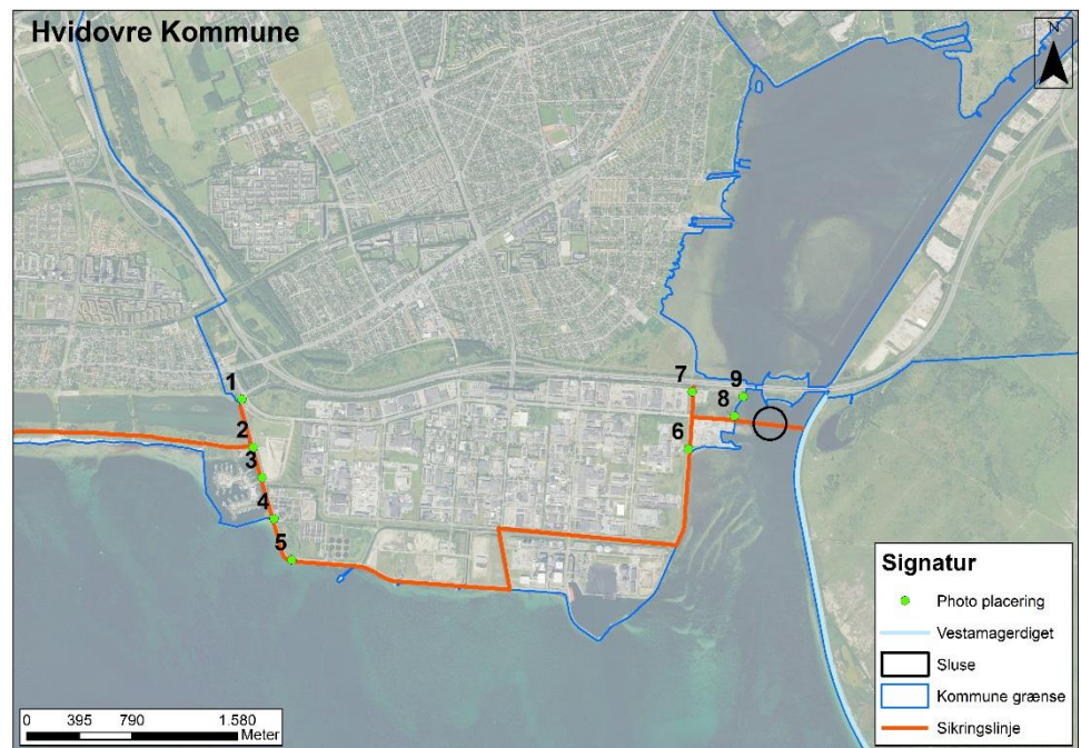
Figur 6-1 Oversigtskort med lokaliteter for fotos. På kortet er vist nuværende sikringslinje omkring Avedøre Holme samt placering af mulig sluse ved indløbet til Københavns Havn. Herved sikres de mest udsatte områder i København og Hvidovre kommuner mod stormflod fra syd.
