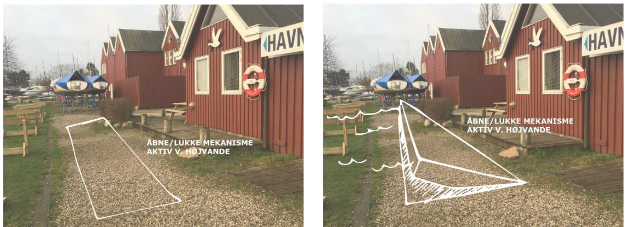
Figur 18 Illustration af ide bag en simpel lukke/åbne mekanisme, baseret på flydende hængslede elementer, som automatisk flyder ovenpå og lukker for vandet ved højvande.
