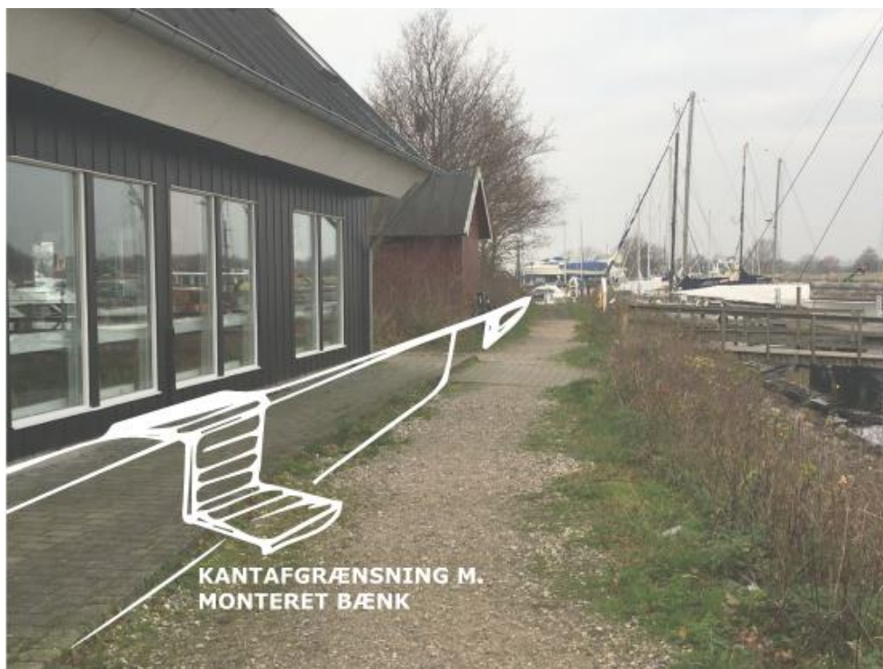
Figur 21 Støttemur for at beskytte restaurant ved Ishøj Havn, som samtidigt kan skabe merværdi med siddepladser.
