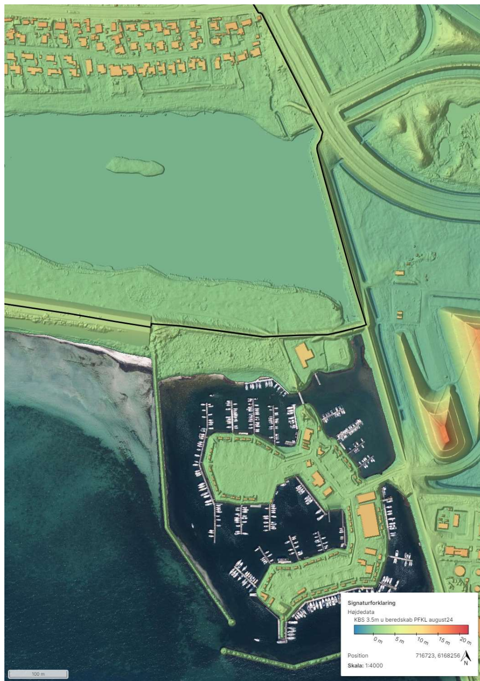
Figur 9-6: 3D præsentation af indre diger med sikringskote 350 cm DVR90 langs landværts del af Brøndby Havn i Brøndby Kommune og tilslutning med højvands sikring i Hvidovre Kommune.
