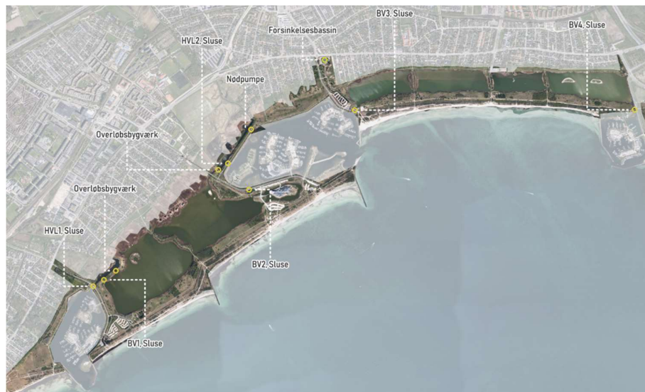
Figur 2-22 Højvandslukker (HVL) og bygværker (BV) i Køge Bugt Strandpark. De 6 slusebygværker leder dels bagvand fra Li. Vejle Å ud via HVL 1 og fra St. Vejleå ud via HVL 2 samt bagvand fra fæstningskanalen/Vestvolden ud via BV 4. Resten håndterer lagunernes vandudskiftning, se også Figur 2-18.
