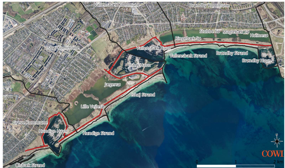
Figur 2-2 Placering af havoversvømmelsesbeskyttelse ved indre og ydre kystbeskyttelse i Køge Bugt Strandpark markeret af den røde linje. Kommunegrænserne er markeret med sort, og et ortofoto fra 2022 er benyttet som baggrund.
