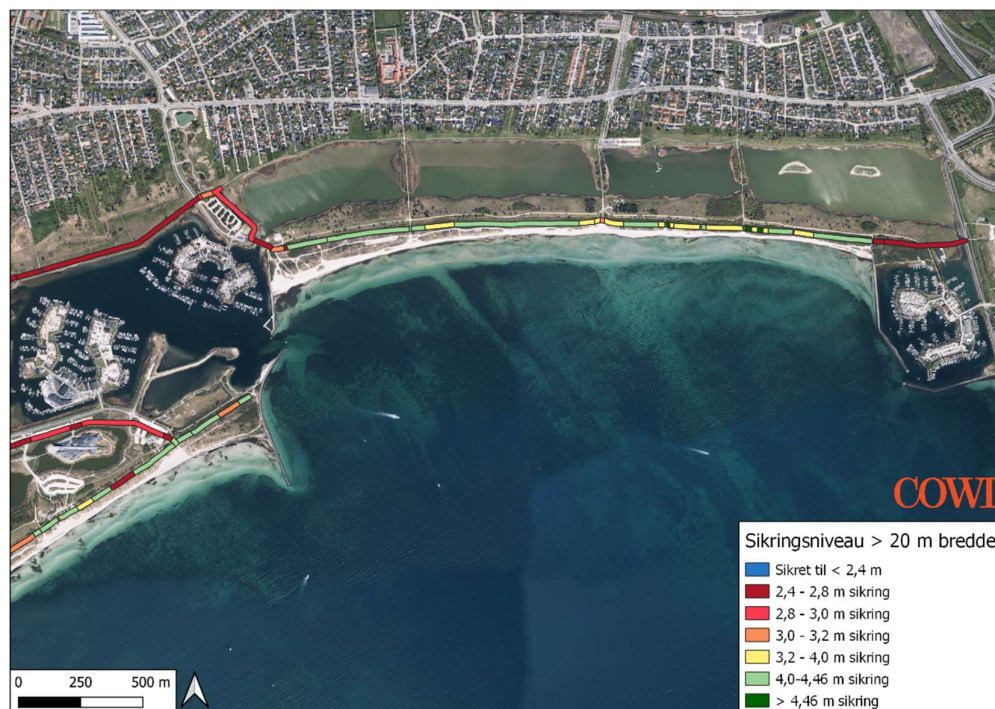
Figur 2-13: Højde af kystbeskyttelsen på det ydre dige med en bredde på mindst 20 m, østlige del af Køge Bugt Strandpark. Højdedate fra DTM2019 (og derved muligvis forældet)
